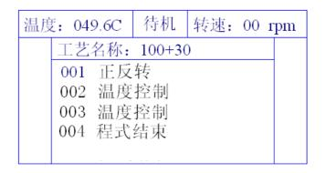
按上或下键移动光标选择要修改的那一步,后按"ok"键,即可按编程一样修改工艺参数,修改完后按"ok"键,最后按"Esc(退出)"键返回复位待机状态画面。
